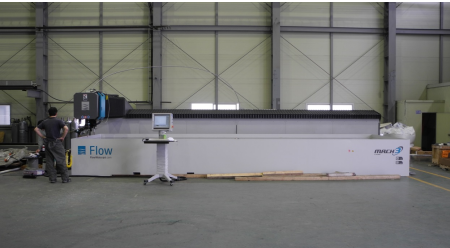
ウォータージェット設備
